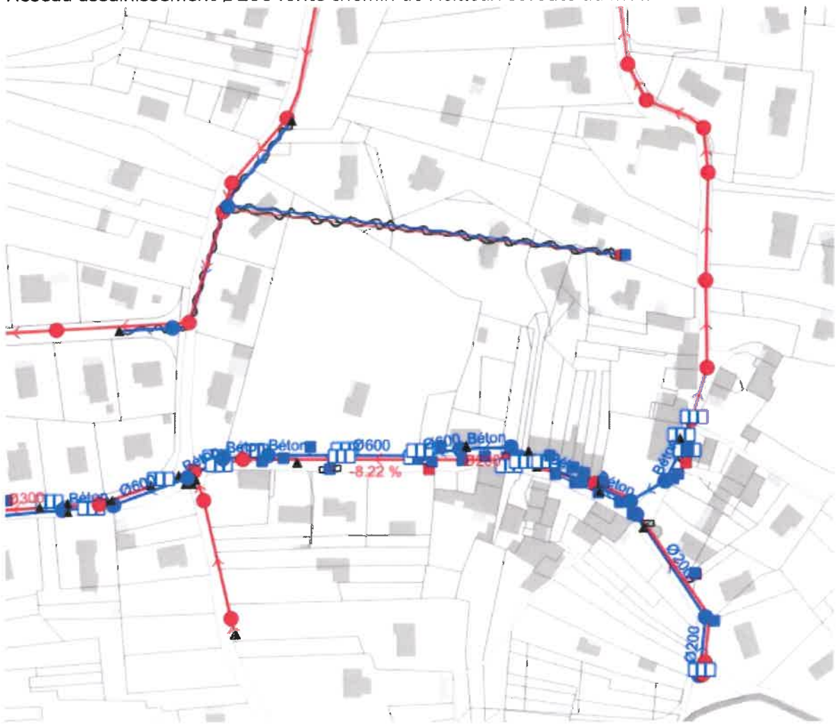
Reilleux Réseau assainissement Ø200 fonte chemin de Reilleux et route du mollard
