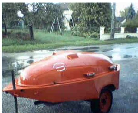
Cette moto-pompe équipée d'un moteur de Peugeot 404 a été mise en service dans les années 80 et fonctionne encore très bien, elle est aujourd'hui très peu utilisée. Elle permettrait en cas de gros sinistre de se mettre en aspiration sur un point d'eau artificielle ou naturelle (piscine ou rivière) et d'alimenter des FPT ou directement des lances à incendie.
